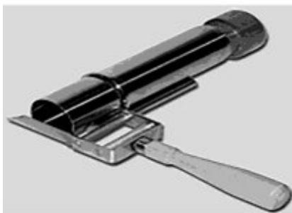
Рис. 1.20. Прибор для определения пористости хлеба КП -101
